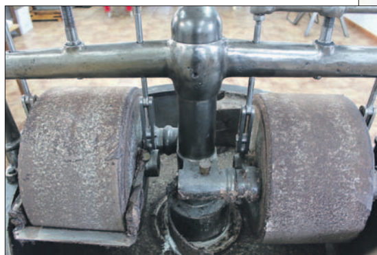
Dos grandes piedras de granito se encargan de mezclar los ingredientes para obtener la masa.
